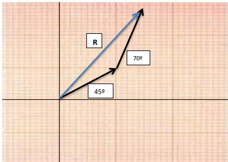
Figura 2.5. Suma de vectores con el método gráfico
