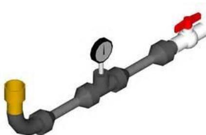
Figura 1.2 Manómetro en tubería
