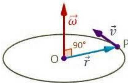
Figura 3.5 Representación de la velocidad angular
