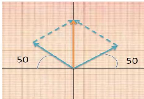
Figura 2.14 Suma de tensiones del remolcador
