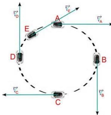
Figura 3.4 Representación del movimiento circular
